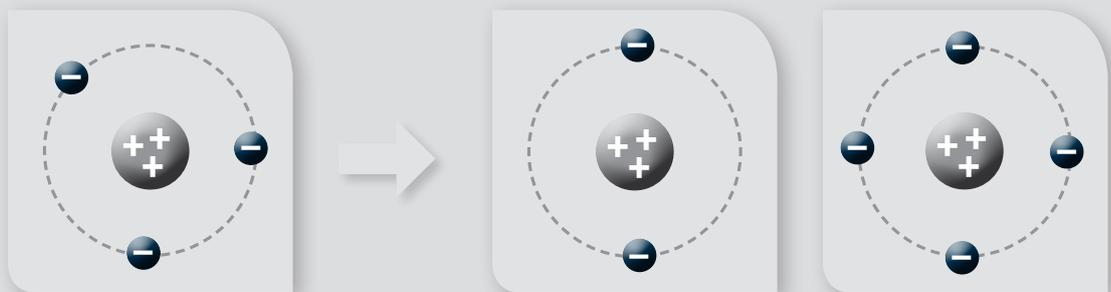
*Aufladung entsteht z.B. durch plötzliche Trennung zweier Grenzschichten, wenn Elektronen von einem Körper auf den anderen überspringen.*
